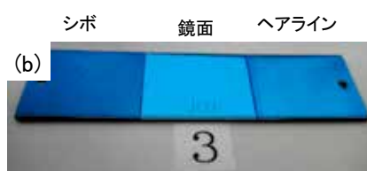
図4 SUS 表面へのカラーリング成膜サンプル
